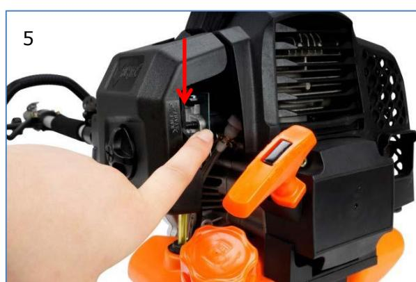
5. Postavite ručicu za start (čok) nakon toga na poziciju „WARM START“ (=TOPLO PALJENJE).
