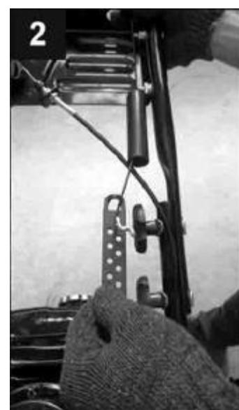
Bowdenovu povlaku iz donje rupe na pločici i ponovno gurnite kraj povlake u jednu od gornjih rupa pločice.
